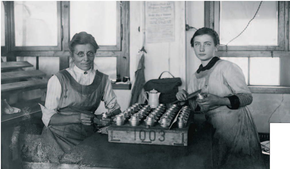
Frauenarbeit bei Leitz in Wetzlar während des Ersten Weltkriegs: Reinigung von Zünderteilen
